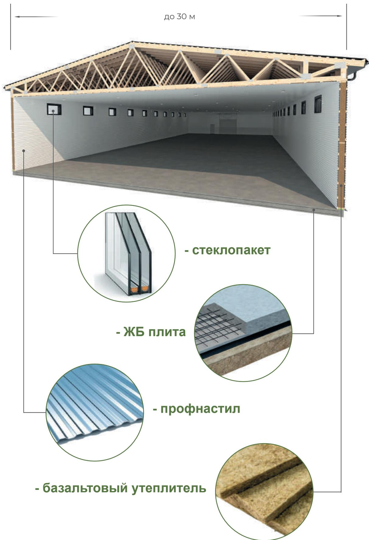
*Стропильные фермы на металлозубчатых пластинах (МЗП) позволяют перекрыть большие пролеты (до 30 метров) без возведения внутренних несущих стен и опор.*
